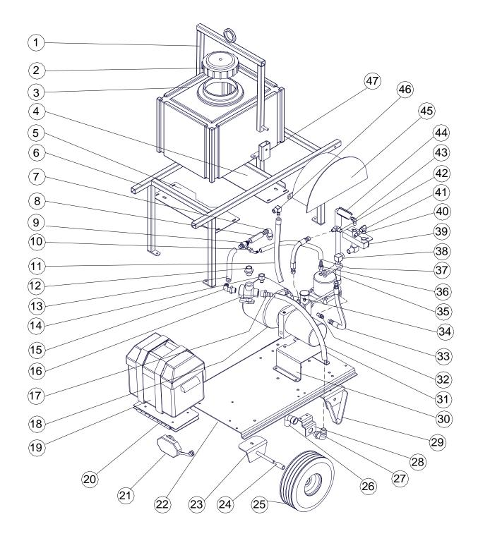
SHORELOCK PUMP, ELECTRIC PARTS BREAKDOWN
